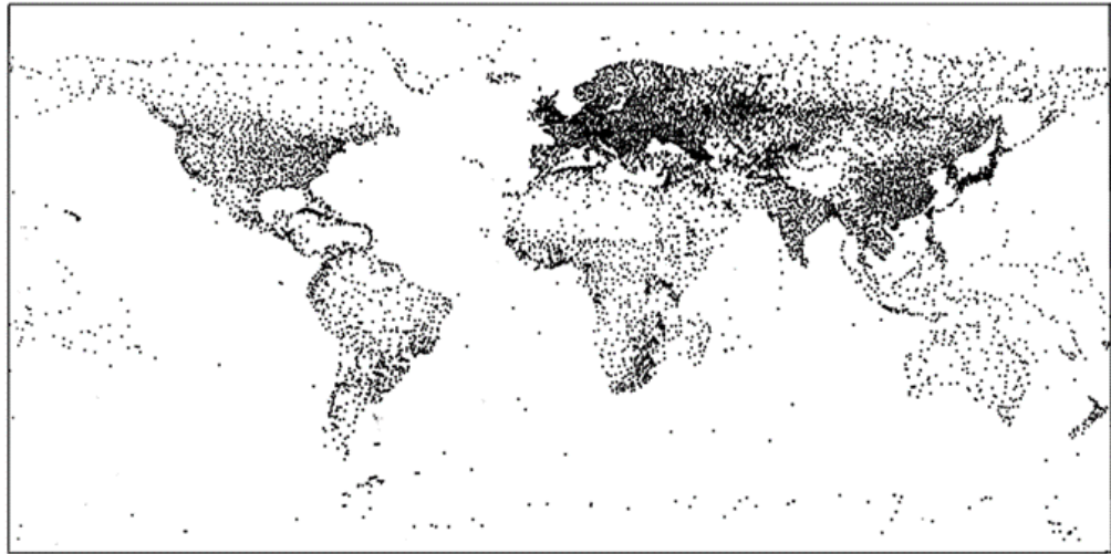
Figura 1. Red de medición pluviométrica (Kidd, 2001).
