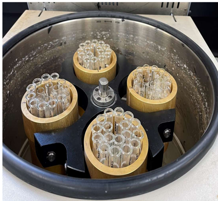
Figura 19: Técnica del Formol- Acetato de Etilo: Muestras debidamente cargadas en la centrífuga. Fuente: Jacklyn Comas.
