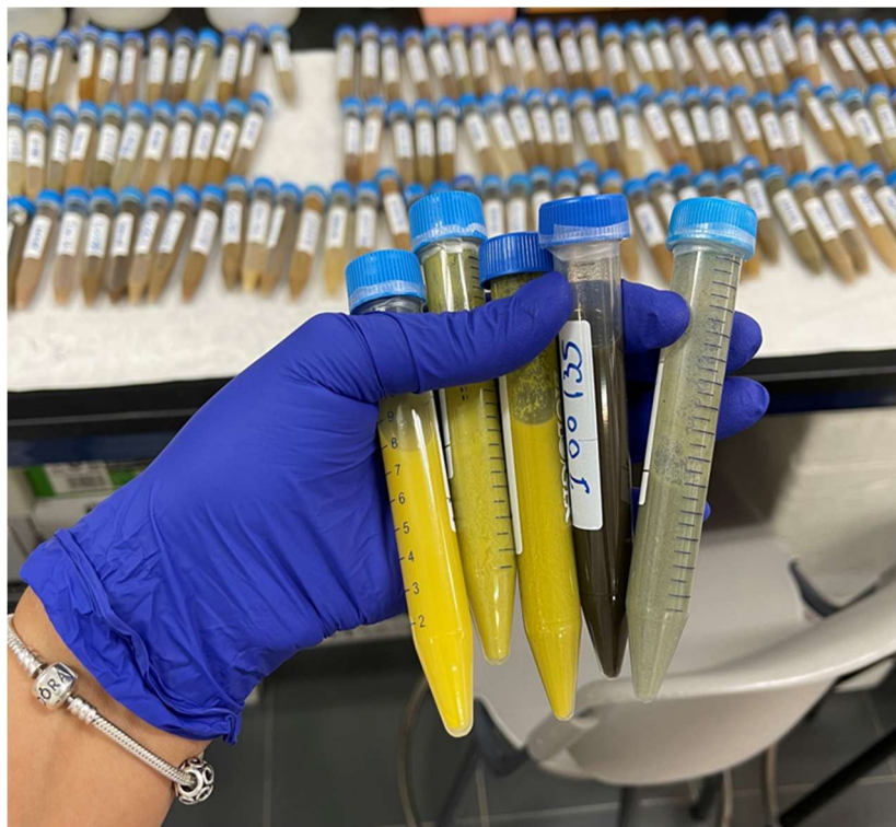
Figura 18: Muestras filtradas, fijadas, rotuladas y selladas con papel parafilm para el transporte aéreo. Fuente: Jacklyn Comas.
