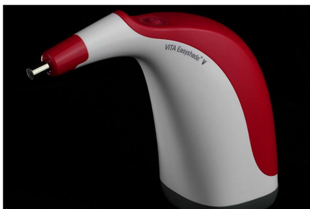
FIGURA 1. Espectrofotómetro para toma de color dental objetiva en forma de pieza de mano ergonómica con un puntero sensor en su externo superior, un botón de disparo y una pantalla para visionar los resultados en su zona posterior.
