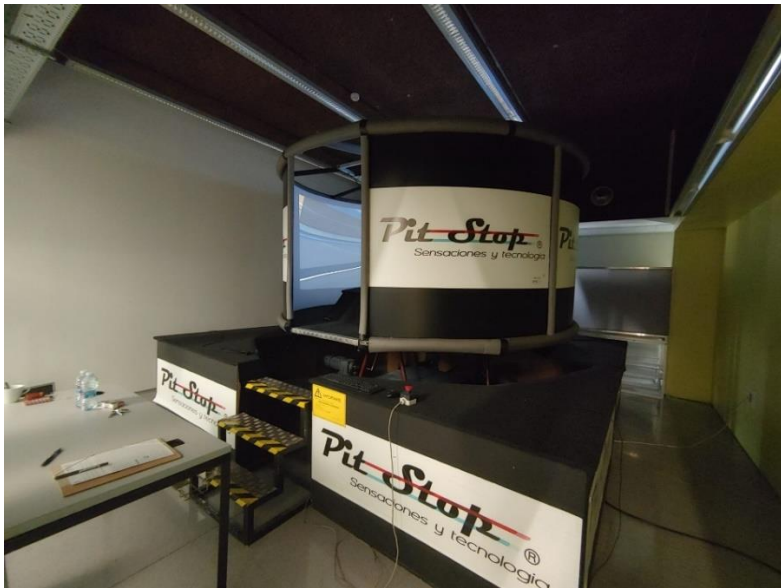
Figura 65: (arriba) diseño de simulador de conducción. (abajo) simulador real construido
