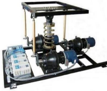
Figura 8: plataforma 3DOF con muelle central
