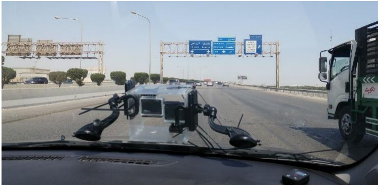
Figura 41: dispositivos de grabación instalados en un coche mientras se filma.
