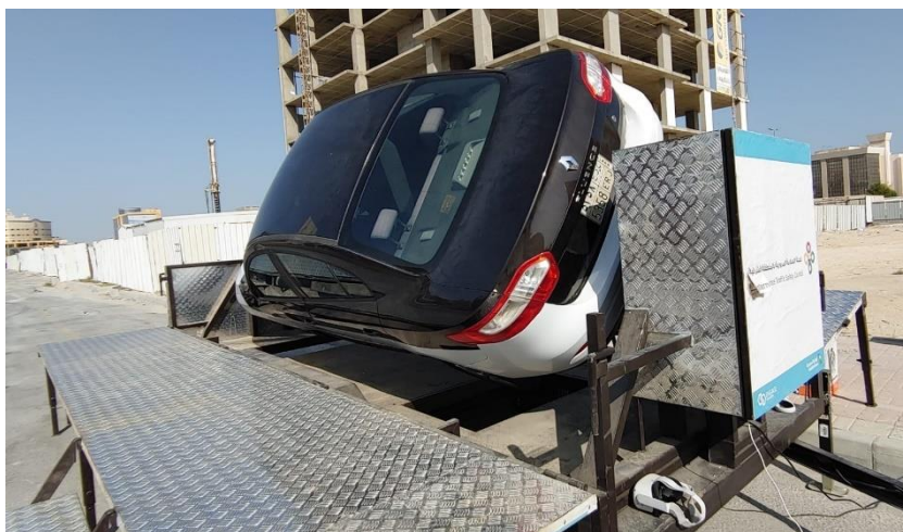
Figura 80: nuevos Roll Over Simulator desarrollados recientemente por el IRTIC. (arriba) diseño. (abajo) sistema real construido.
