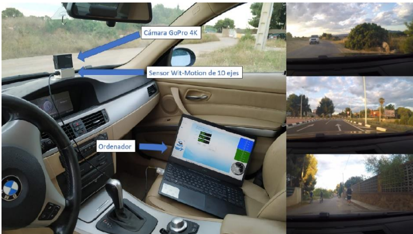
Figura 50: instalación de sensor, cámara y laptop para recogida de muestras reales
