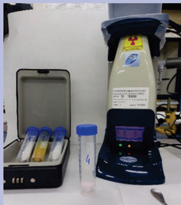
Figura 5: Contenido de la caja número dos, y espectrómetro de fluorescencia de rayos X portátil.
