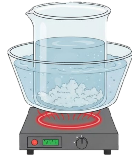
Digestión del precipitado en un baño María
