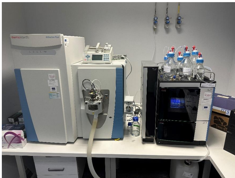
Figura 25. Sistema de separación cromatográfica Vanquish™ acoplado a espectrómetro de masas Orbitrap Q Exactive™ Plus.
