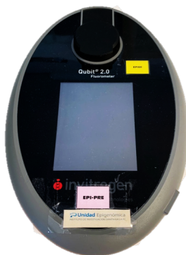
Figura 8. Qubit ® 2.0 Fluorometer (Invitrogen) empleado para la cuantificación de ADN.
