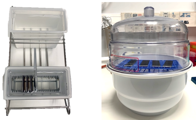
Figura 19. Lavado y secado de los BeadChips en bomba de vacío.
