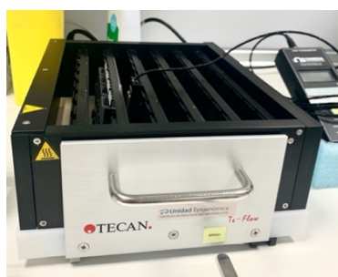
Figura 18. Dispositivo de baño en seco Tecan (Te-Flow flow-through chamber).
