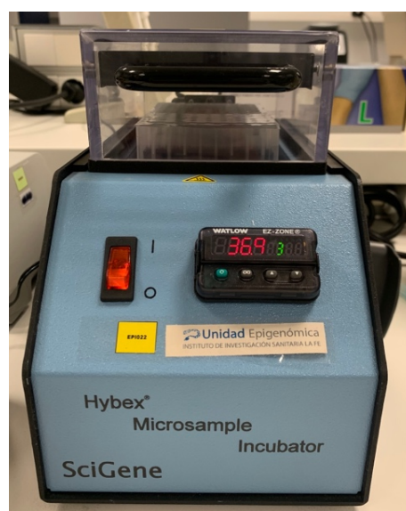
Figura 15. Hybex Microsample Incubator empleado para la fragmentación de ADN.
