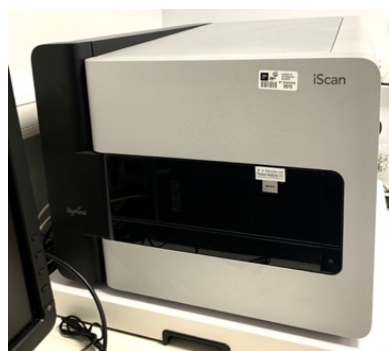
Figura 20. Escáner fluorescente Illumina iScan SQ empleado para realizar la lectura de BeadChips.
