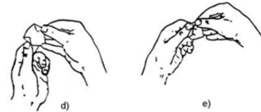
Doblado del papel para su introducción en el crisol
