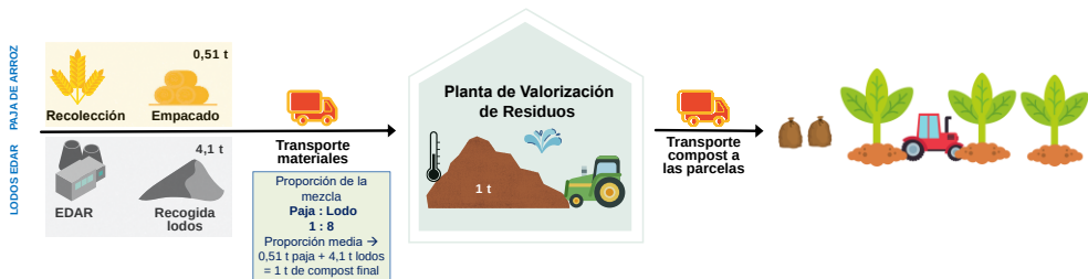
Figura 28. Descripción del proceso evaluado desde la recogida de materiales, el proceso de compostaje y su posterior aplicación en campo.
