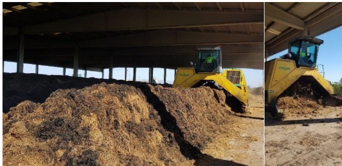
Figura 5. Volteo de las pilas a lo largo del proceso.
