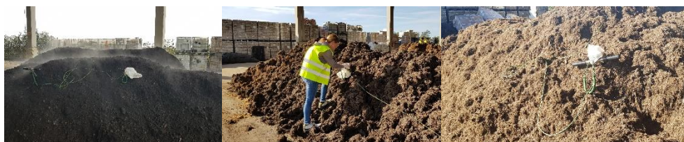
Figura 4. Detalle de las sondas colocadas en las pilas para la medida de la temperatura.
