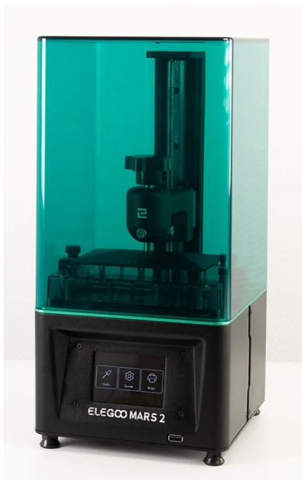
Figura 12: Fotografía de la impresora Elegoo Mars 2© empleada en el presente estudio.
