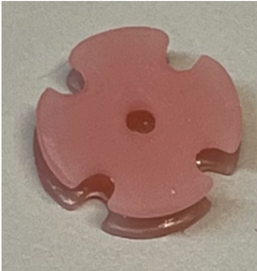
Figura 20: Pieza del modelo C impresa con la resina Optiprint® Lumina en la impresora Elegoo Mars 2 donde se muestran los orificios de 2 mm de diámetro espaciados cada 2 mm.
