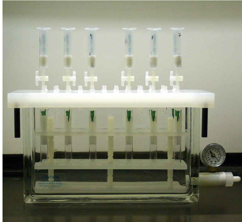
Montaje de SPE utilizando una bomba de vacío.
