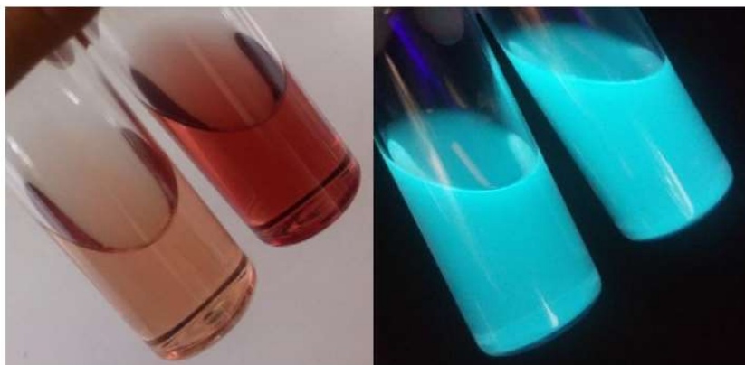
Figura 28: Cambio de fluorescencia ( 10^{-5}M y 10^{-4} M de 23 en MeOH) antes y después de la exposición a CO
