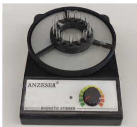
Figura 4.1. Dispositivo multiextracción de 15 posiciones empleado para llevar a cabo mSBSDE.
