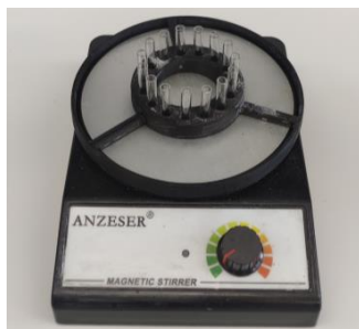
Figura 5.1. Dispositivo multiextracción de 15 posiciones empleado para llevar a cabo la mSBSDME.
