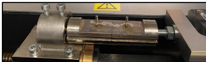
FIGURA 15. Cadena elastomérica de 5 módulos tras la prueba de extensión.
