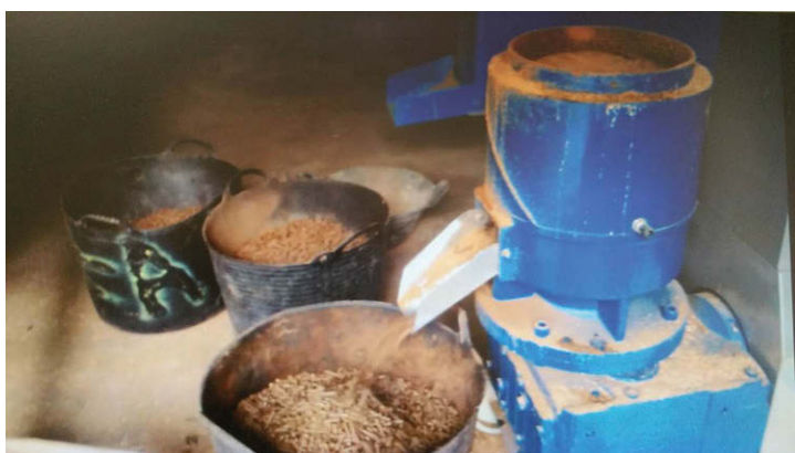
Fotografía 9. Peletizadora de 15 kW en funcionamiento.
