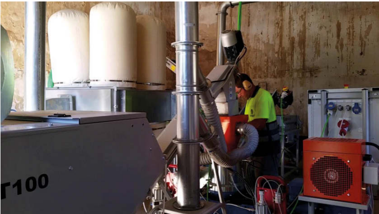
Fotografía 10. Puesta en marcha de la línea semi industrial de peletizado.
