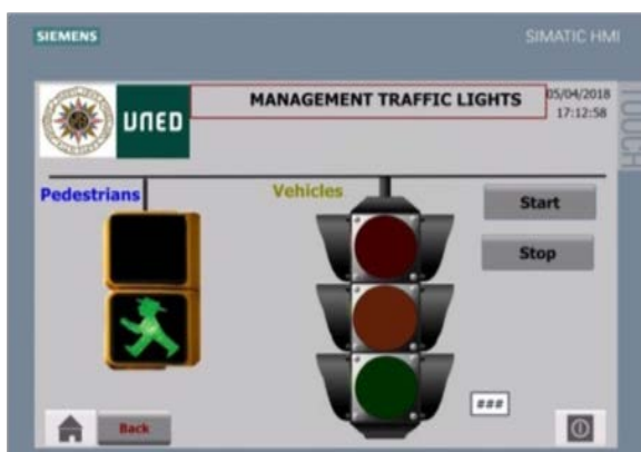
Fig. 10. Control de tráfico a través del HMI.
