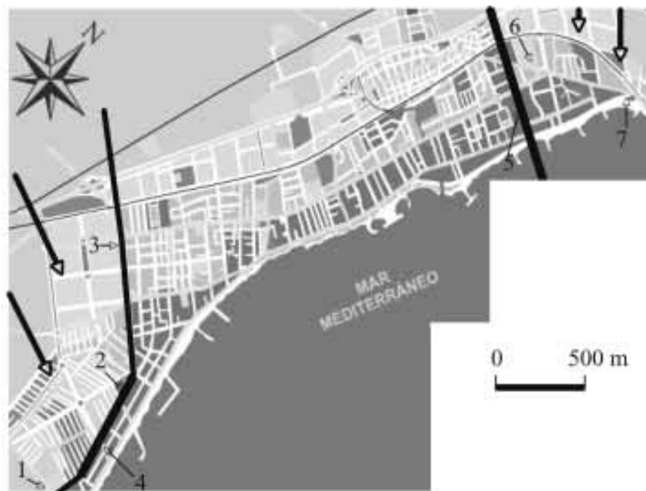
Figura 4. Plano de Benicàssim. Las zonas enmarcadas son las que se inundan frecuentemente. Las flechas indican la dirección de las aguas desbordadas. 1. La Ratlla; 2. Dr. Fleming. 3. Mohino. 4. Rafael Balaguer. 5. Avda. Jorge Comín. 6. Avda. Barcelona. 7. Voramar.
